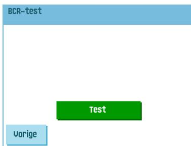
2. Druk op de knop **[Test]** om de BCR-test te starten. Nadat de test is voltooid, verschijnt het scherm Resultaat.
