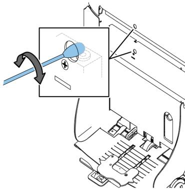
So reinigen Sie die Ausgangsfotozellen:
