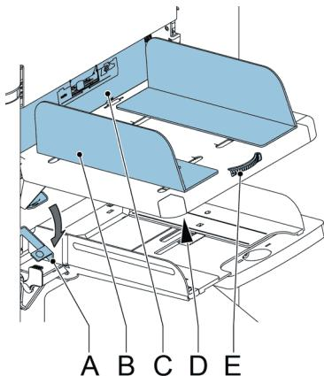
1. Lösen Sie den Drehknopf **D** um eine halbe Drehung.
