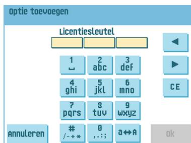
2. Gebruik het toetsenblok om de licentiesleutelcode in te voeren die u van de leverancier hebt ontvangen om de betreffende optie op deze machine te activeren.
