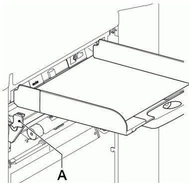
2. Dokumentzufuhrablage zum Entriegeln anheben und anschließend aus der Zuführung ziehen.
