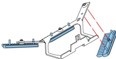
Maak de borstels van de envelopverzegeling schoon als deze vuil of verzadigd zijn of vervang de borstels als volgt:
