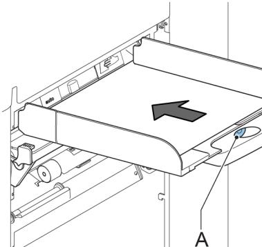
2. Leg een document op de feederlade en schuif deze ongeveer 60 mm (2,4 inch) in de machine (draai de knop **A** tegen de klok in als de scheiding te krap is ingesteld).
