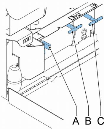
Zo nodig kunnen de enveloppen en documenten handmatig worden getransporteerd naar de vultafel of de onderste enveloptrack met hendel **C**. Als u een ingevoegd document handmatig wilt transportereren, haalt u hendel **B** over.
