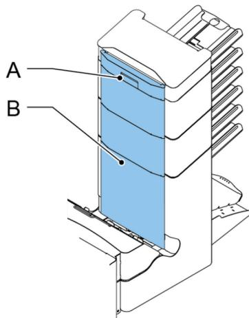
1. Griff **A** für den vertikalen Transport nach oben ziehen, um die Abdeckung **B** für den vertikalen Transport zu öffnen.
