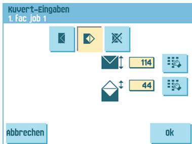
Ganz oben auf dem Bildschirm sind drei Auswahlschaltflächen verfügbar, von denen eine gewählt werden kann. Die gewählte Einstellungsschaltfläche wird hervorgehoben.
