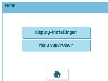
2. Kies of u het menu Display-instellingen of het menu Supervisor wilt zien. Druk op de bijbehorende knop om dat menu te openen. Let op: als u het menu "Supervisor" wilt openen, voert u de PIN-code **2546** in. Na invoering van de juiste pincode verschijnt het menu "Supervisor".
