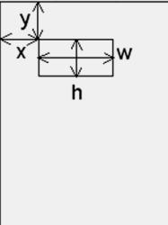
Die Position der Adresse auf dem Adressträger, gemessen von der linken oberen Ecke. Die Adressposition besteht aus einer horizontalen x-Koordinate, einer vertikalen y-Koordinate, der horizontalen Breite "w" und der vertikalen Höhe "h".                                                                                                                                                                     |
