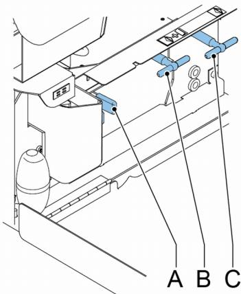
Bei Bedarf können Kuverts und Dokumente manuell mit Hilfe von Hebel **C** zum Kuvertiertisch oder zur unteren Kuvertführung transportiert werden. Hebel **B** drehen, um ein kuvertiertes Dokument manuell zu transportieren.
