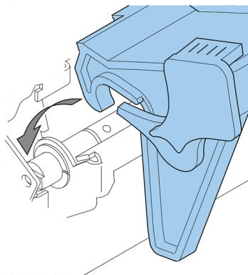
4. Dokumentzufuhrablage auf die Maschine zu bewegen und Haken über die Befestigungen (auf beiden Seiten) schieben.
