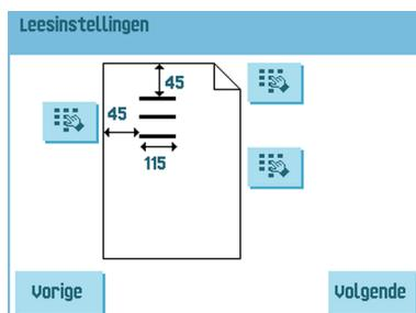
In dit menu kunt u de locatie en de breedte van de OMR-code. De positie vanaf de bovenkant moet tussen de 15 mm en de documentlengte min 20 mm liggen. Als u op **[Next]** (Volgende) drukt, kunt u een OMR-vel laden om de OMR-instellingen te controleren. Het systeem verwerkt het OMR-vel en geeft de leestekens weer. Via de informatieknop wordt de interpretatie van de leestekens weergegeven.
