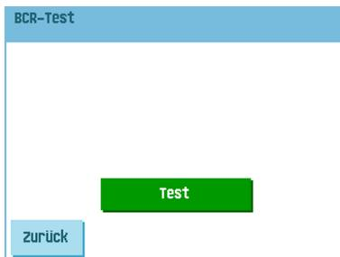
2. Auf die Schaltfläche **[Test]** drücken, um den BCR-Test zu starten. Nachdem der Test abgeschlossen ist, wird der Bildschirm "Ergebnis" angezeigt.
