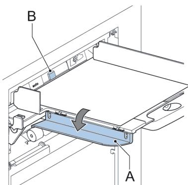
2. Linke Seitenführung **A** der oberen Zuführung nach unten kippen. Jetzt wird der Tagespostschalter **B** angezeigt.
