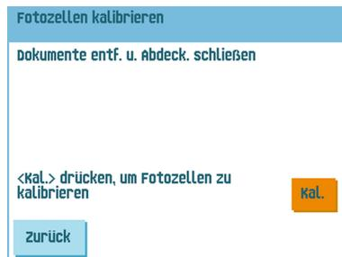
2. Alle Dokumente und Kuverts entnehmen und alle Abdeckungen schließen, bevor die Kalibrierung gestartet wird.
