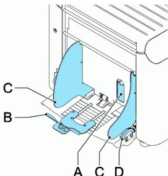
9. Draai envelopsteun **B** om het gewicht van de enveloppen gelijk over beide zijden te verdelen.
