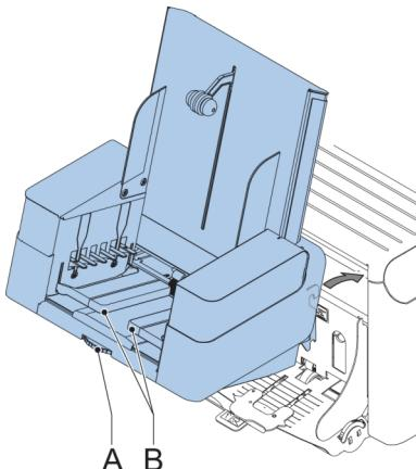
De verticale stapelaar met hoge capaciteit kan worden gebruikt om gevulde enveloppen te stapelen. De verticale stapelaar kan tot 325 gevulde enveloppen opslaan. Als u over een verticale stapelaar met hoge capaciteit beschikt, moet u deze als volgt op uw systeem installeren:
