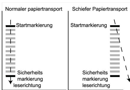
Der Mindestcode ist eine Markierung in einer Zeile (Kuvertierung). Aus Gründen der Zuverlässigkeit wird jedoch empfohlen, mindestens 2 Markierungen zu verwenden. Die erste Zeile ist die Startmarkierung. Eine Markierung auf der zweiten Zeile bedeutet Kuvertieren. Keine Markierung auf der zweiten Zeile bedeutet Sammeln.
