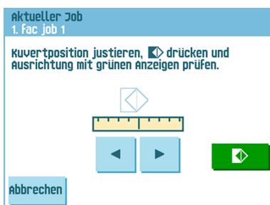
2. Die Kuvertposition mit Hilfe der Pfeile unter dem Lineal justieren.
