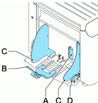
9. Kuvertstütze **B** drehen, um das Gewicht der Kuverts auf beiden Seiten gleichmäßig zu verteilen.
