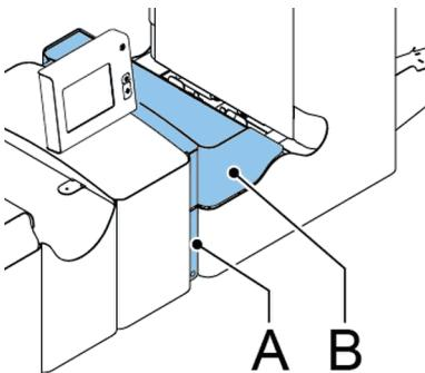
1. Druk op het onderste deel van de ontgrendelhendel **A** om de kap van de Folder **B** te openen.
