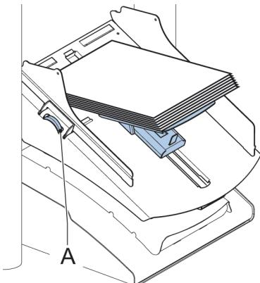
2. Seitenführungen durch Drehen des Rändelrads **A** einstellen, bis die Dokumente/Rückumschläge genau passen und noch genügend Spiel bleibt.
