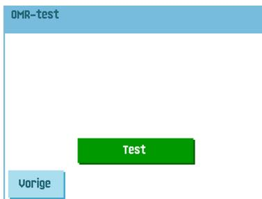
2. Druk op de knop **[Test]** om de OMR-test te starten. Nadat de test is voltooid, verschijnt het scherm Resultaat.
