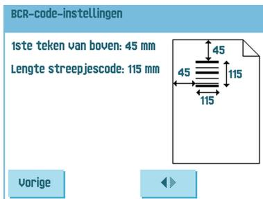
4. Bevestig in het scherm BCR-instellingen dat alle instellingen correct zijn gelezen. Merk op dat dit scherm uit twee onderdelen bestaat. Gebruik de pijlen onder aan het scherm om tussen de twee onderdelen van dit scherm te navigeren.
