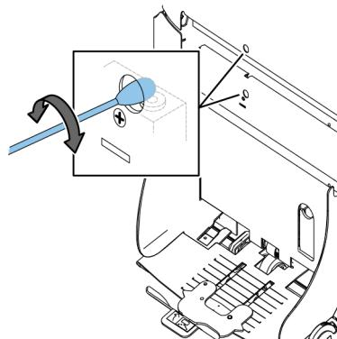
U kunt de uitvoersensoren als volgt reinigen:
