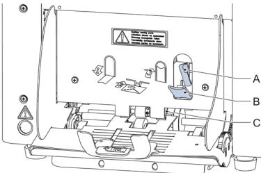
1. Kleinen Hebel **B** nach unten ziehen. Stift **C** wird abgesenkt.
