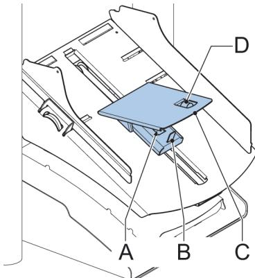
2. Die Zuführplatte **C** in die hintere Position schieben
