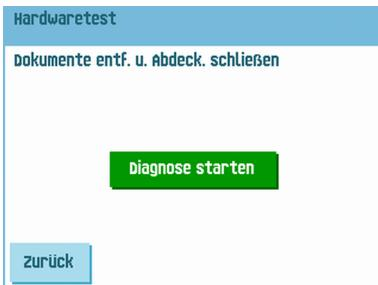
2. Alle Dokumente und Kuverts entnehmen und alle Abdeckungen schließen, bevor die Diagnose gestartet wird.
