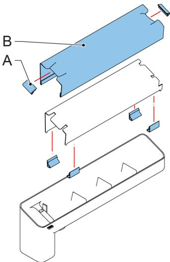
Anfeuchtfilz reinigen oder bei Bedarf ersetzen, wenn dieser verschmutzt oder verklebt ist. Gehen Sie wie folgt vor:
