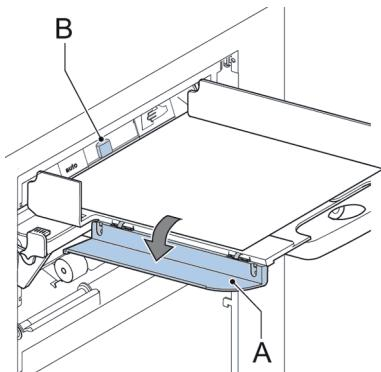
2. Draai de linkerzijgeleider **A** van de bovenste lade omlaag. De hendel Dagpost **B** wordt zichtbaar.
