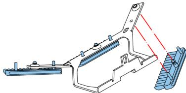
Verschmutzte oder verklebte Bürsten für den Kuvertverschluss wie folgt reinigen oder ersetzen:
