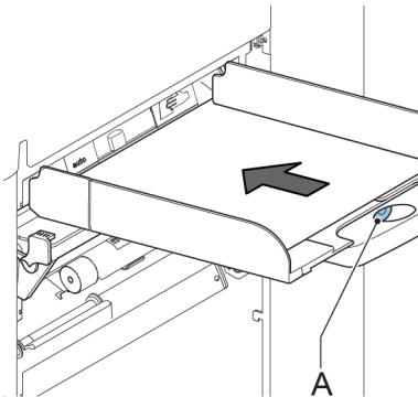
2. Dokument auf die Zufuhrablage legen und ungefähr 60 mm (2,4 Zoll) in das System schieben (Knopf **A** entgegen dem Uhrzeigersinn drehen, wenn die Separation zu eng eingestellt ist).
