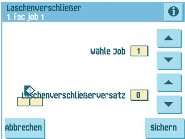
2. Verwenden Sie die Pfeile neben "Versatz für Laschenverschließer", um den Laschenverschließerversatz für den ausgewählten Job zu ändern. Der Versatz kann zwischen -20 und 20 variieren. Wenn für den Versatz z. B. der Wert +10 eingestellt wird, erfolgt die Aktivierung des Verschließvorgangs 10 Takte später als ursprünglich.
