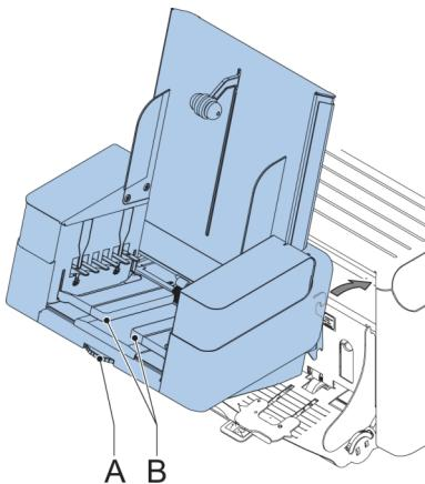
Die vertikale Ablage mit hoher Kapazität kann zum Stapeln gefüllter Kuverts verwendet werden. Die vertikale Ablage kann bis zu 325 gefüllte Kuverts aufnehmen. Falls Sie eine Ablage mit hoher Kapazität besitzen, installieren Sie sie wie folgt in Ihrem System:
