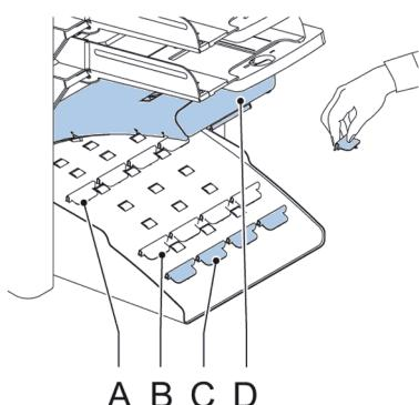
Wenn ein Job ausgewählt wird, für den eine andere Anschlagsposition programmiert wurde, dann muss der Bediener die Dokumentanschläge an die richtige Position setzen (wie auf der Anzeige dargestellt).
