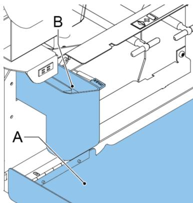
2. Flüssigkeitstank **B** bis zum Rand "Max" mit Verschlussflüssigkeit füllen.
