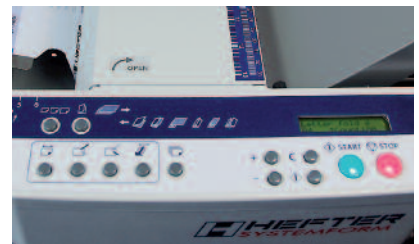
TF MEGA-A: Übersichtliches Bedientableau mit Display, Job- und Vorwahlzähler
