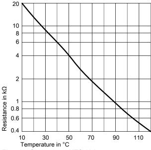
Fig. 51 Sensor type: NTC 10  $k\Omega$
