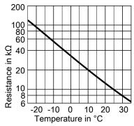
Fig. 44 Sensor type: NTC 10  $k\Omega$
