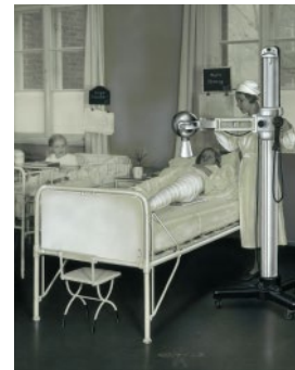
Siemens-Röntgenkugel, der transportable Röntgenapparat mit der nur handbreiten, ölsolierten Röntgenröhre (1935)
