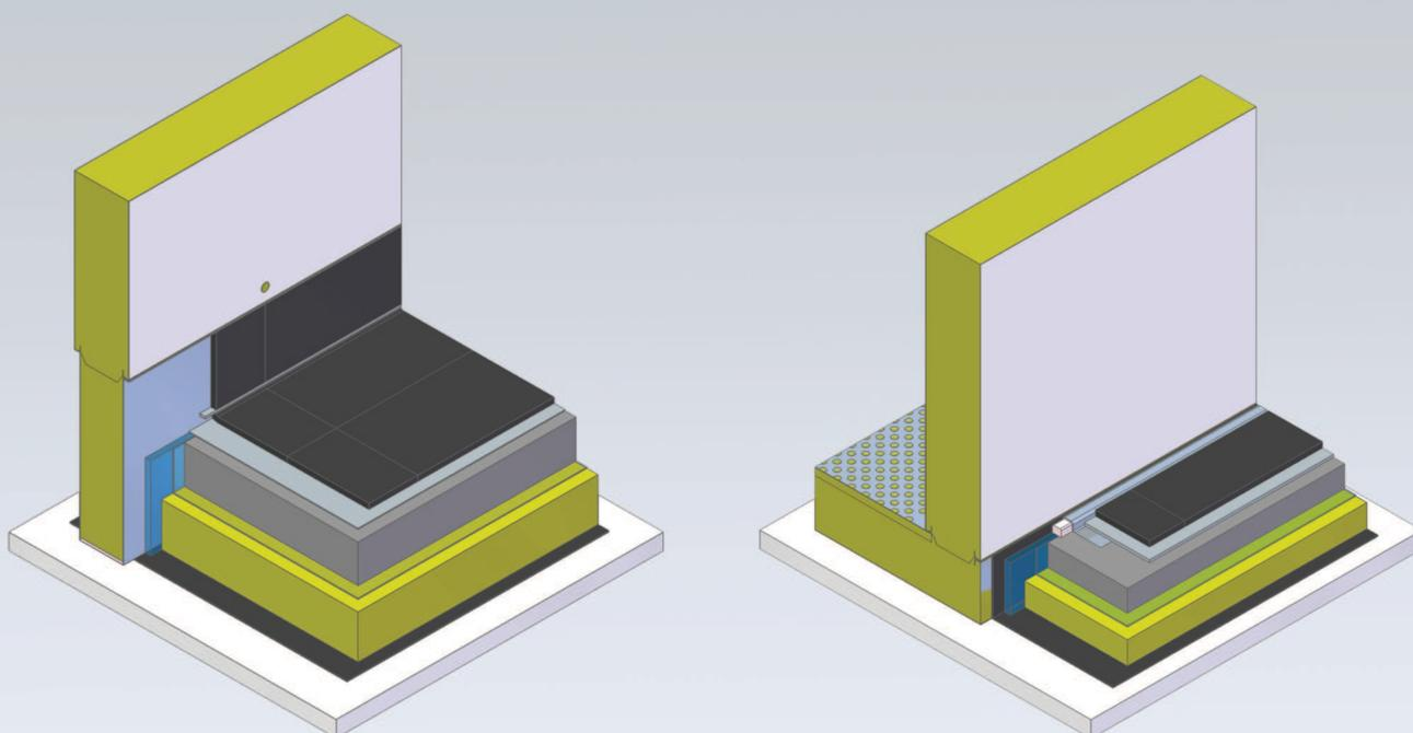
**Fixation avec adaptateur pour plancher conventionnel devant la chambre froide ou à l'intérieur**
