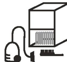
Если модуль контроллера указывает на высокое давление в конденсаторе, проверьте конденсатор и при необходимости очистите его. Если проблема не устранена, обратитесь в сервисный центр.
