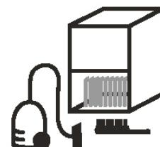
Falls die Steuereinheit einen Druckanstieg meldet, kontrollieren Sie den Kondensator auf Verschmutzungen und säubern Sie ihn bei Bedarf. Falls die Störung dadurch nicht behoben werden kann, wenden Sie sich bitte an Ihren Wartungsdienst.
