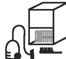
Hvis kontrollenheten indikerer at det er høyt trykk i kondensatoren, sjekk kondensatoren og rengjør den om nødvendig. Hvis kabinetet ikke virker etter denne prosedyren, kontakt service.
