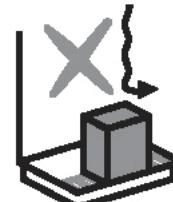
**Remarque** L'armoire n'est pas conçue pour refroidir les produits mais pour les maintenir à la température à laquelle ils doivent être conservés. Les produits alimentaires dont la température est supérieure à la température spécifiée ne doivent pas être placés dans l'armoire.
