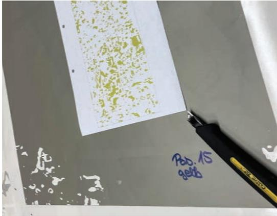
Folienplott, zu bearbeitende Flächen werden ausgehoben
