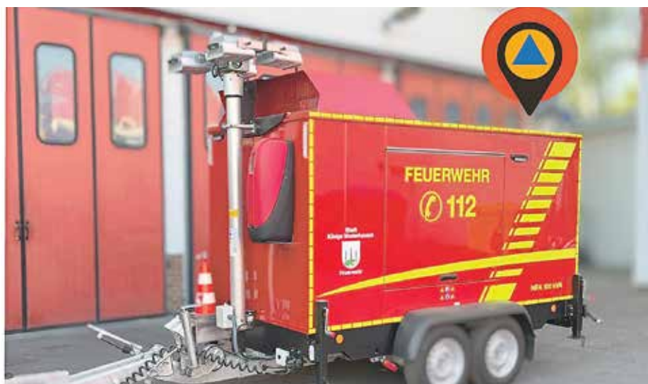
Bei einem Ausfall der Stromversorgung kann mit diesem Notstromaggregat die Versorgung eines Leuchtturms sichergestellt werden. Foto: Stadt Königs Wusterhausen
