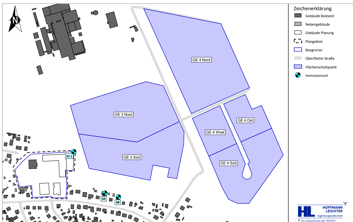
Abbildung 4-1 Lage der Schallquellen zum Anlagenlärm | Vorbelastung
