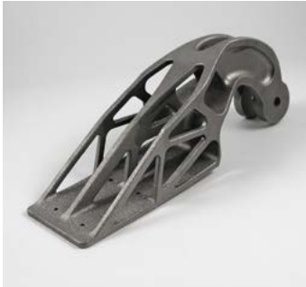
Scharnier in Leichtbauweise für Turbinenabdeckung am Airbus A380, Werkstoff: EOS Titanium Ti64 (Quelle: EADS/EOS GmbH)
