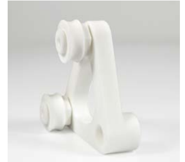
Kleiner Kompensator für IPCM, FORMIGA P 110, Werkstoff: PA 2200 (Quelle: EOS GmbH)
