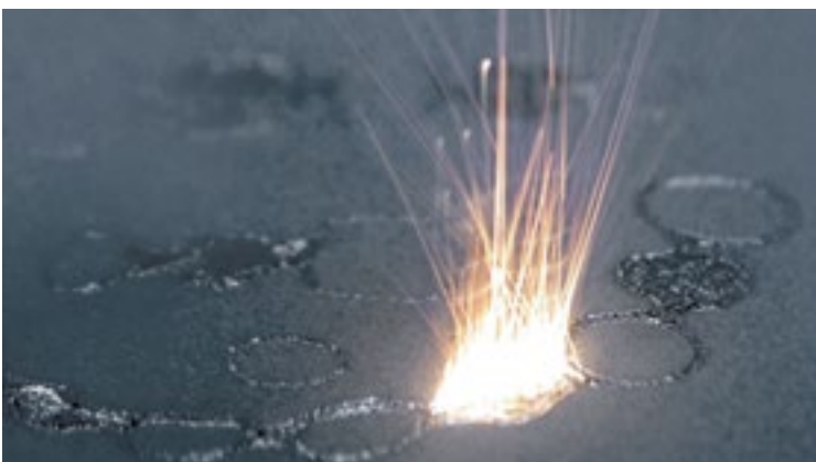
DMLS-Prozess zur additiven Fertigung von Zahnersatz
