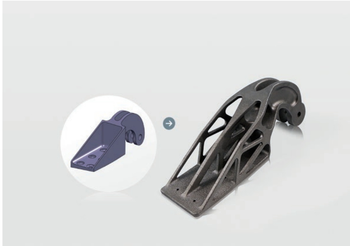
Visuel d'une charnière pour fonderie conventionnelle en acier (image de gauche) et charnière en titane avec topologie optimisée par frittage laser (Source : EADS)
