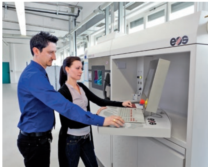
Fabrication chez MTU : Un des 7 systèmes EOS qui produit des composants de série pour la fabrication de moteurs (source : MTU Aero Engines).
