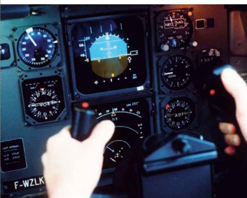
Das Cockpit des Airbus A310 ist erstmals für ein Flugzeug dieser Größenordnung nur für zwei Piloten ohne Flugingenieur ausgelegt. Auch die Bildschirme sind eine Premiere.
