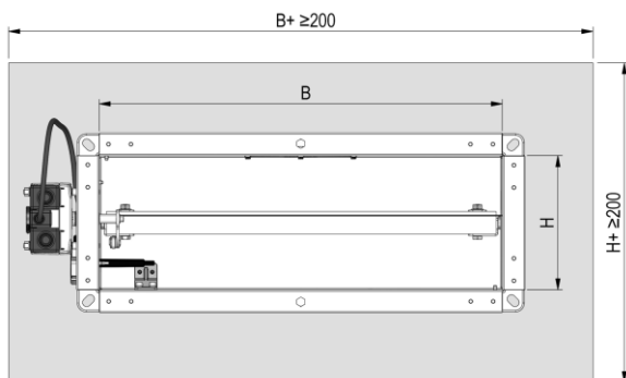
Abbildung 10: Einbau in massive Decken mit Betonsockel, Draufsicht
